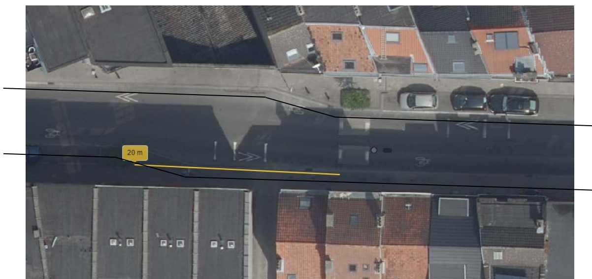
Figure 62 : Distance trop courte entre les cousins et la chicane, ne permettant pas un bon alignement des bus par rapport à l'axe longitudinal des cousins (rue Joseph Wauters à Schaerbeek) ; ces derniers ont été enlevés par la suite
