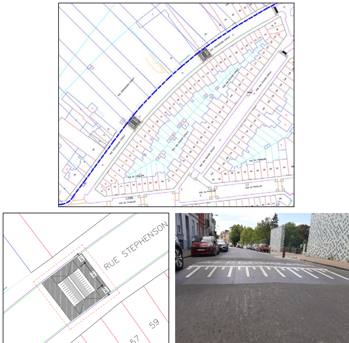
Figure 58 : Aménagement de deux ralentisseurs (L. 4,8 m, ht. 12 cm) à l'aide de rampes préfabriquées à la rue Stephenson
