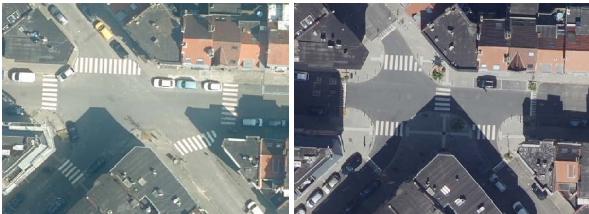
Figure 36 : Implantation d'un plateau en carrefour, permettant d'une part, de raccourcir les traversées piétonnes et de les repositionner selon les lignes de cheminement naturel, et d'autre part, d'améliorer l'accessibilité et de modérer les vitesses (carrefour rue Gerlache et rue de Haerne à Etterbeek)
