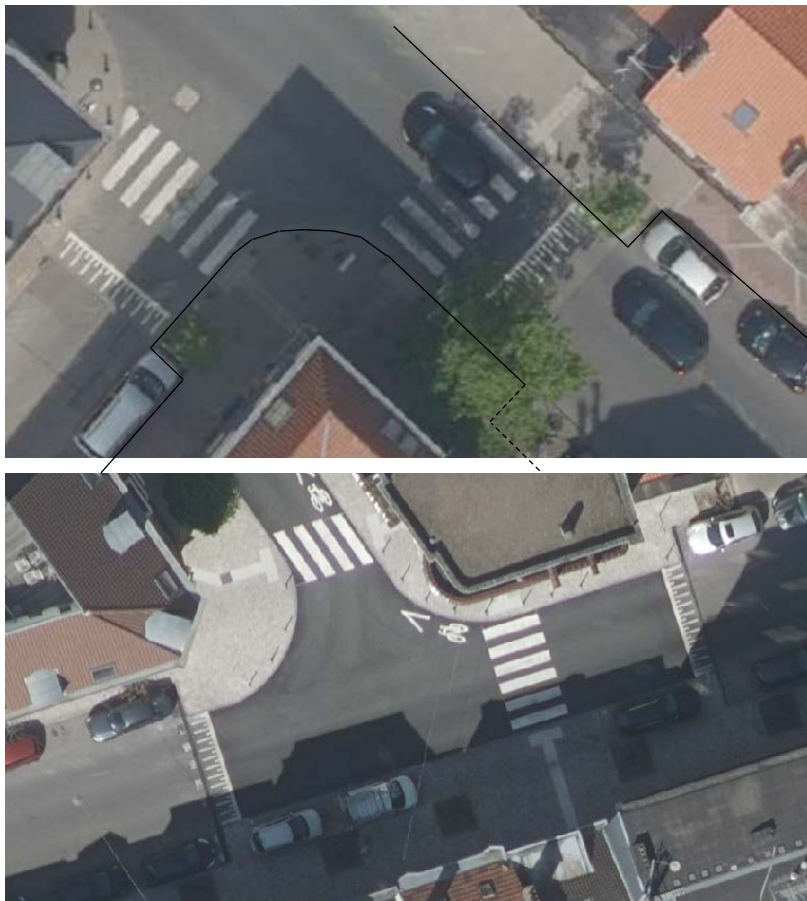
Figure 23 : Implantation de plateaux en carrefour, tenant compte de la visibilité réciproque entre piétons et usagers motorisés (le stationnement n'est toléré que moyennant des mesures spécifiques)
