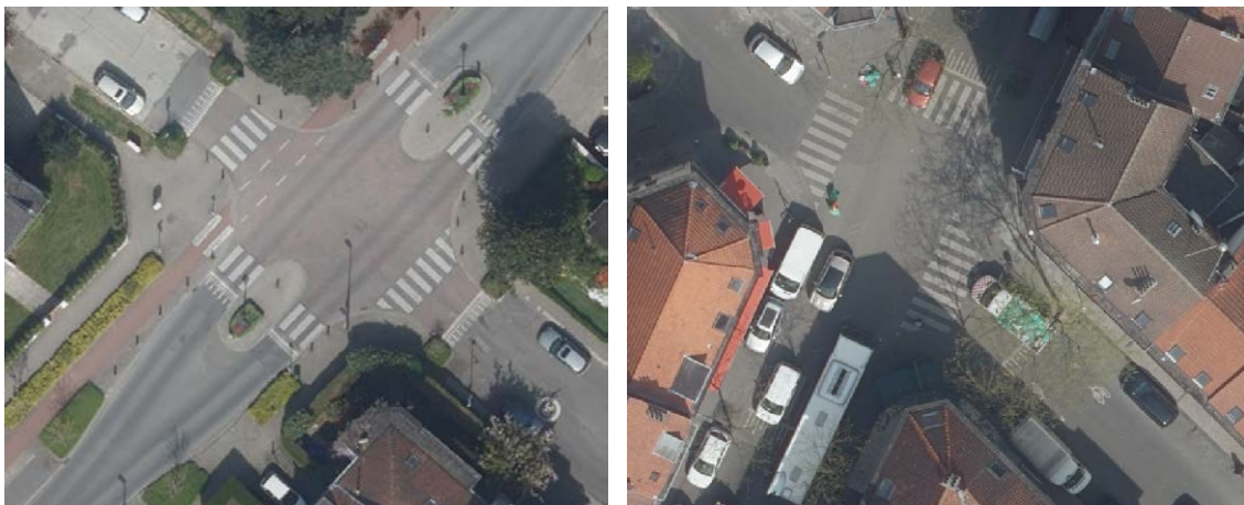
Figure 38 : Distance insuffisante entre le marquage en peigne des rampes d'accès et le marquage de la traversée piétonne - Croisements entre l'av. Grandchamps et l'av. Montgolfier à Woluwe-Saint-Pierre (photo de gauche) ; entre la rue des Coteaux et la rue de la Consolation à Schaerbeek (photo de droite)
