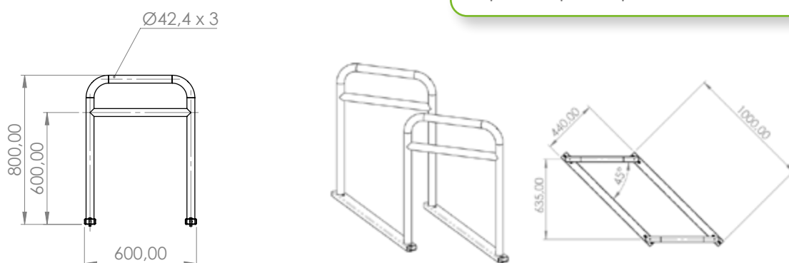
11 - Afmetingen van de omgekeerde U-bogen met tussenbuis geleverd door Brussel Mobiliteit (2021)
