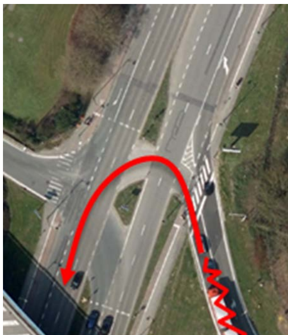
Illustratie : geometrie en capaciteit van de afrit van de binnenring, die niet aangepast zijn voor stromen van voertuigen die naar Sint-Pieters-Leeuw gaan; 'snelwegachtige' configuratie van de invoegstrook van de afrit van de Ring richting stad
